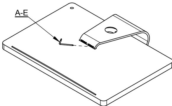
步驟三：將③與iMAC螢幕對齊放置後鎖入M3星型皿頭螺絲固定。
