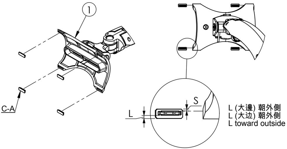
步驟五：將①依圖與③對齊放置後鎖入A-F固定。
