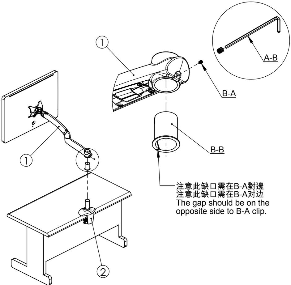
註：產品組裝完畢後請視螢幕重量使用A-C調整"彈簧調整塊"，重螢幕往"H"方向調整，輕螢幕往"L"方向調整。
