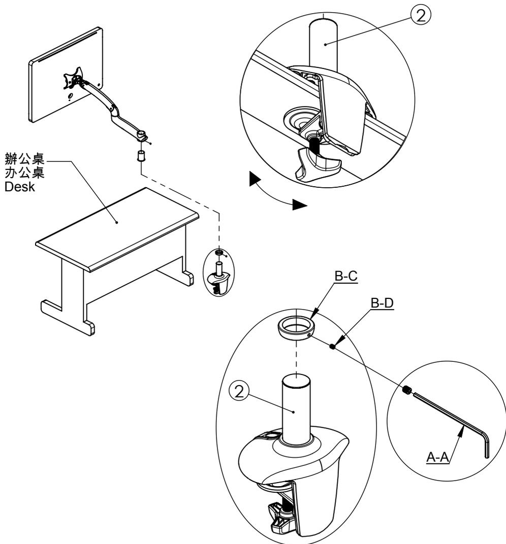
步驟八：再將B-B依圖套入至①孔內到底。(注意圖示缺口方向)
