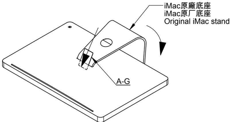
步驟二：插片一邊繼續插入一邊再將底座折向下，直至看到M3星型螺絲頭露出後，再使用A-E工具拆卸，拆卸下來的8顆螺絲請收好後面會用到。
