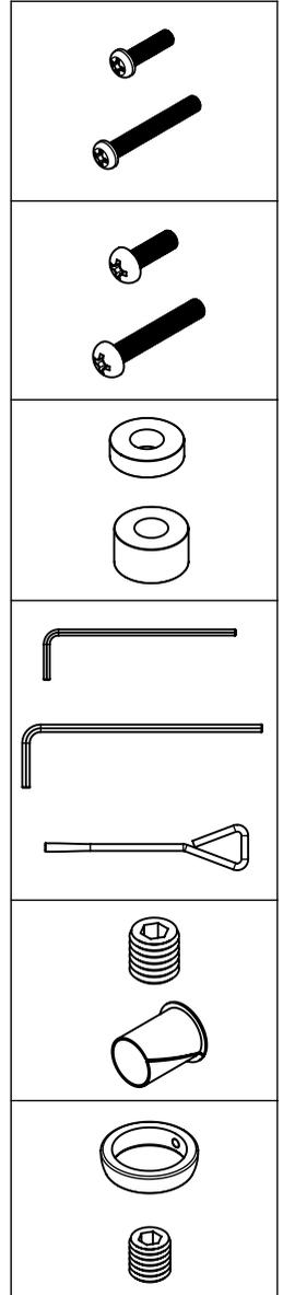
步驟一：將A-1或A-2螺絲照圖依序穿過①、A-3塑膠墊片再鎖入電腦螢幕鎖緊固定。
