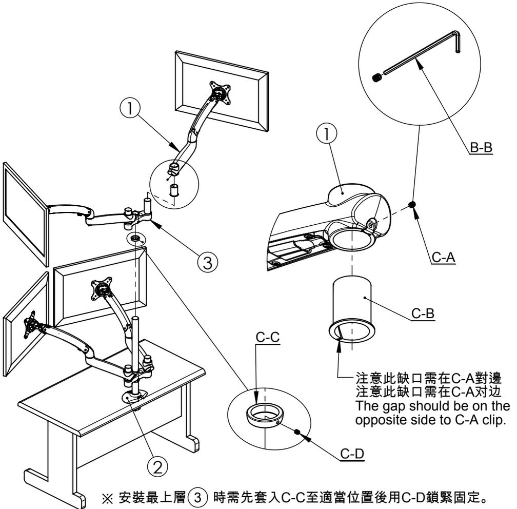
※ 安裝最上層③時需先套入C-C至適當位置後用C-D鎖緊固定。
