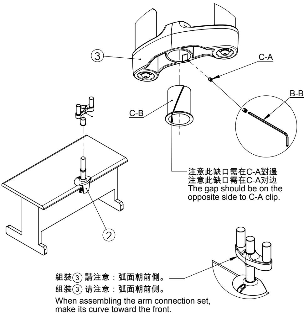
步驟六：再將C-B依圖套入至①孔內到底。(注意圖示缺口方向)
